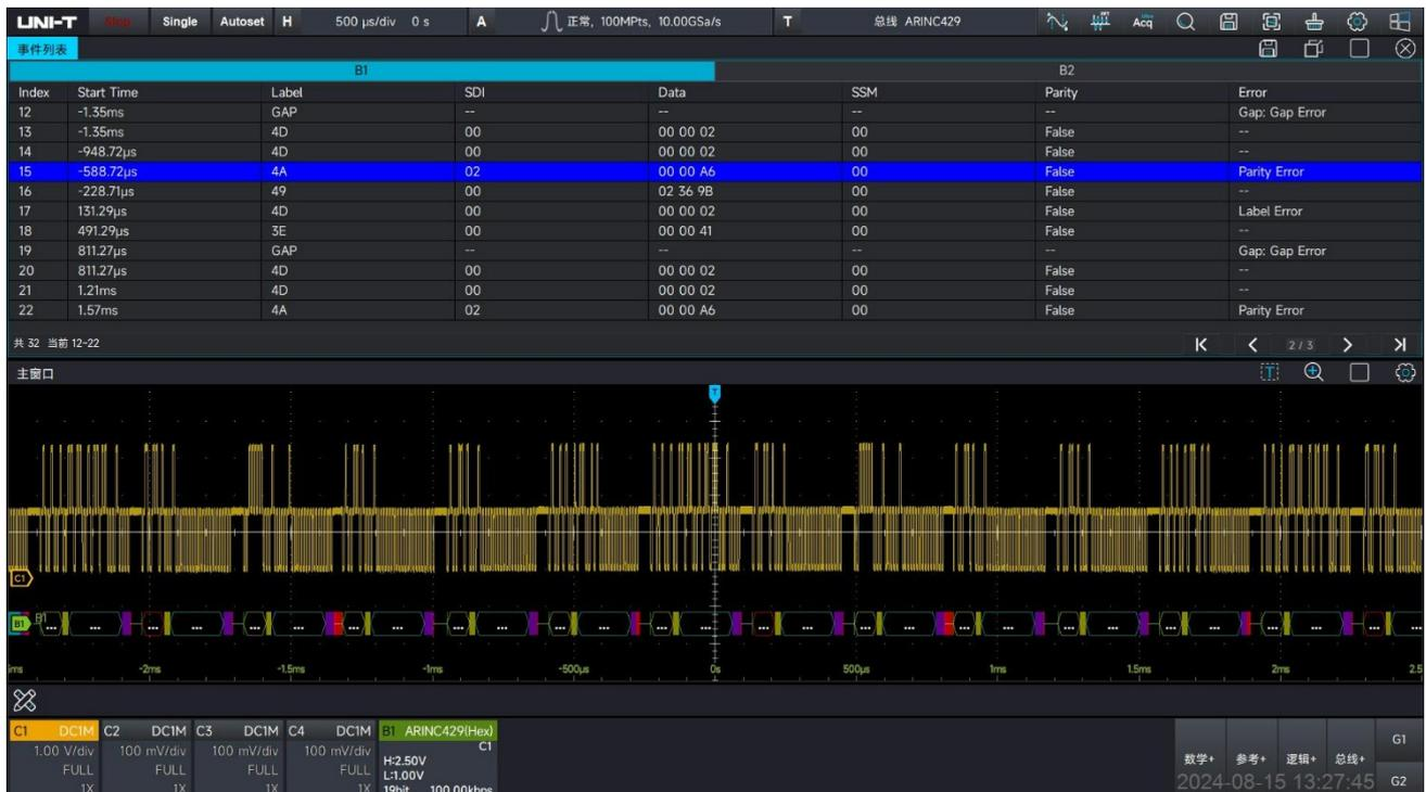
您不必注重对 ARINC429 总线解码过程的复杂格式转化，对编码译码中繁琐的转化工作可以交给示波器来完成。比如，您可以使用大家都易懂的 ASCII 编码来确定传输数据正确性，一旦错误，可以记下这个时间戳，将译码转化为 16 进制或二进制的方式去定位机器编码的故障。在这个阶段，事件列表很容易将错误的信息记录，您可以导出译码数据表分析二进制数
