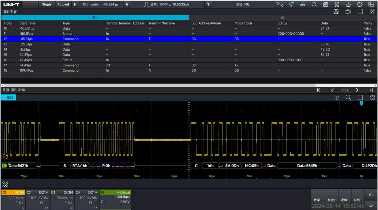
您不必注重对 1553 总线解码过程的复杂格式转化，对编码译码中繁琐的转化工作可以交给示波器来完成。比如，您可以使用大家都易懂的 ASCII 编码来确定传输数据正确性，一旦错误，可以记下这个时间戳，将译码转化为 16 进制或二进制的方式去定位机器编码的故障。在这个阶段，事件列表很容易将错误的信息记录，您可以导出译码数据表分析二进制数据的传输和波形的关系。
