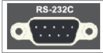
图 5-1 RS232C 连接器后视图
