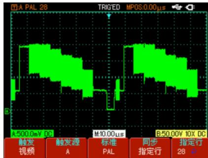
图2-17视频触发：行同步
