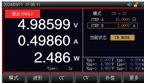
组合测试:CR+CC,CV+CR, CV+CC
