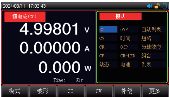
四种定态测试模式:CC、CV、CR、CP动态测试
