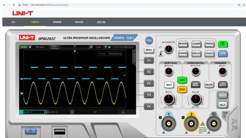
内嵌 Web Server，通过浏览器即可对仪器进行远程控制、观察波形、获取测量结果，可满足高压、高温等特殊环境的应用需求。无需安装驱动软件和上位机软件，即可实现跨平台操控。UPO6000Z 系列内嵌的虚拟控制面板和示波器面板完全相同，支持 PC 的网页布局，使用起来更加简单方便。
