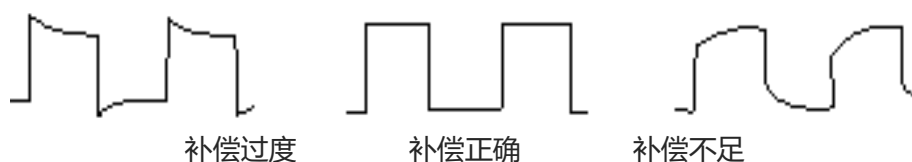
图 2 探头补偿校正
