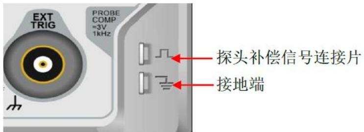
图 1 探头补偿信号连接片和接地端
