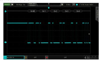
解码速度大大提升。深存储 56Mpts 下的全内存硬件解码,解码时间由十几秒提高到了毫秒级,实现了实时解码,极大提高用户的问题诊断效率。
