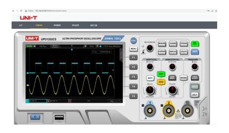
内嵌 Web Server,通过浏览器即可对仪器进行远程控制、观察波形、获取测量结果,可满足高压、高温等特殊环境的应用需求。无需安装驱动软件和上位机软件,即可实现跨平台操控。UPO1000CS 系列内嵌的虚拟控制面板和示波器面板完全相同,支持 PC 的网页布局,使用起来更加简单方便。
