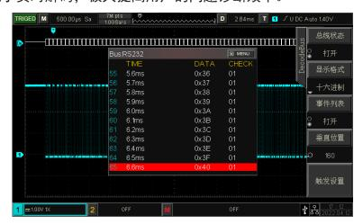
解码的同时不会影响波形刷新速度,且波形具有数字荧光显示效果;
