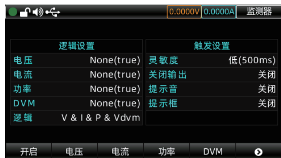
监测器功能: 用于监测输出数据或进行触发设置
