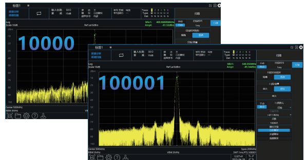
提供最高到 100001 个扫描点数,提供更高的频率分辨率,更易捕捉不易被发现的信号
