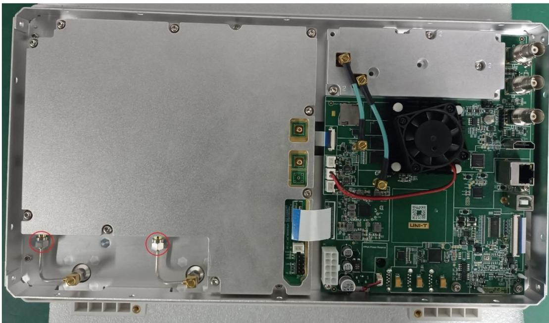
3、使用 T10 内梅花螺丝刀拆下前盖板组件固定腔体的 9 颗螺丝，如下图：
