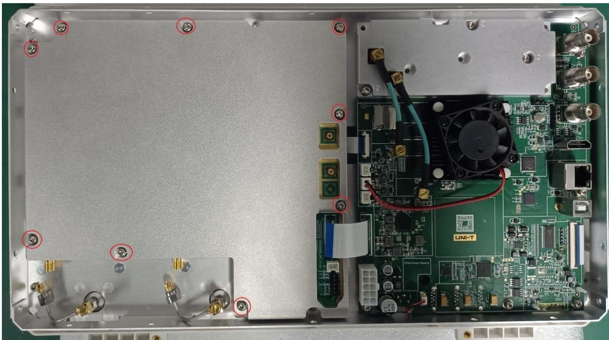
4、取出腔体，再使用 T10 内梅花螺丝刀拆下腔体固定射频板的所有螺丝，如下图：
