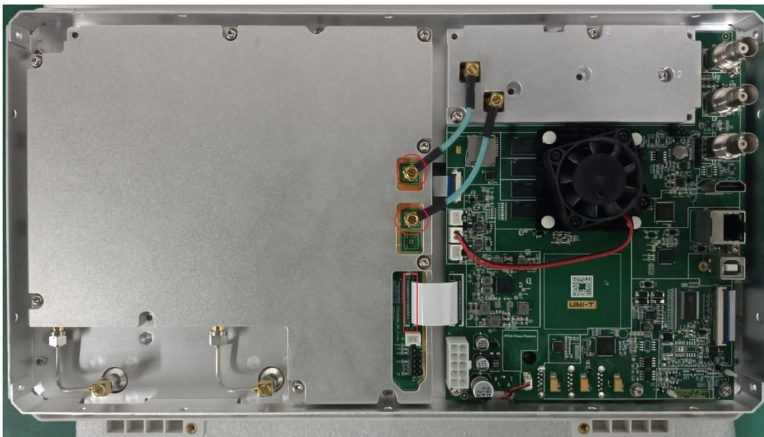
2、使用力矩扳手拆下 SMA 螺丝，如下图：
