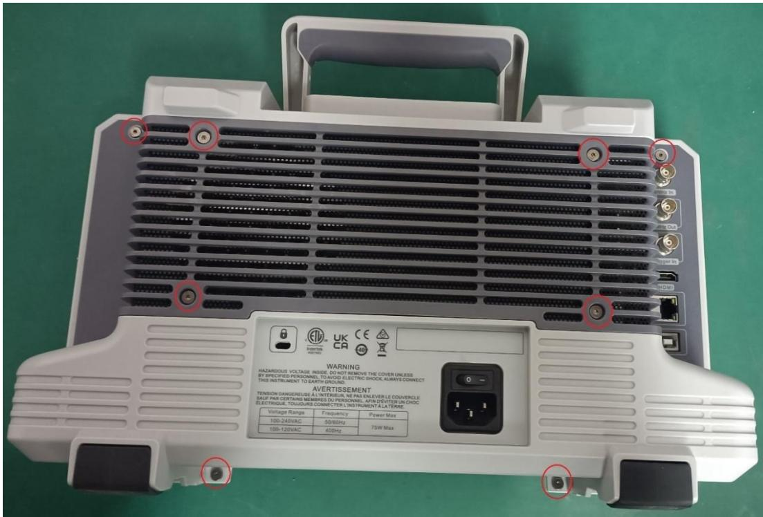
5、用 T8 内梅花螺丝刀拆开机壳后盖组件的 8 颗螺丝。如下图：
