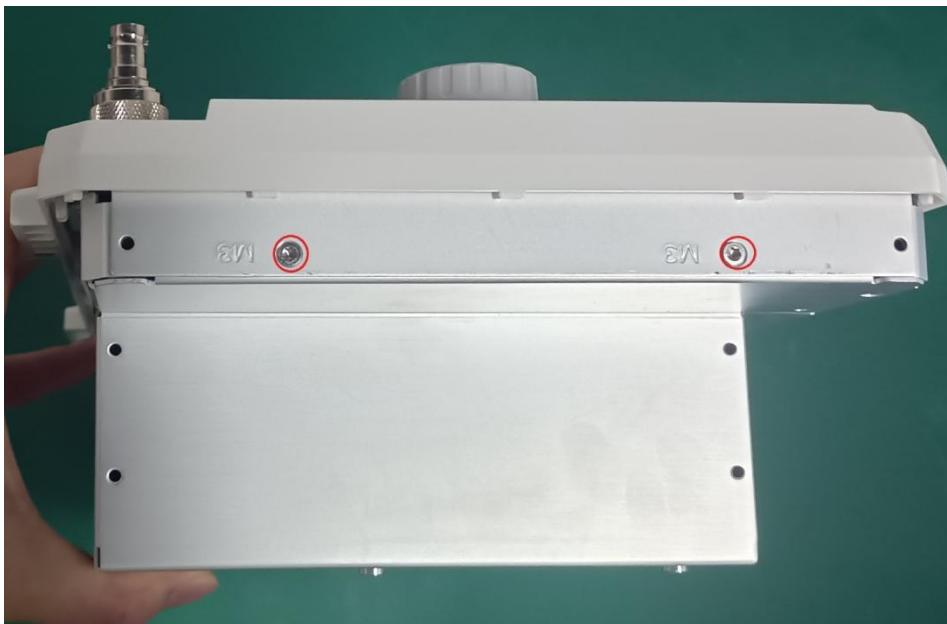
3、将设备面板朝下放置在软垫上，小心向上取后盖组件，并去掉连接前盖组件和后盖组件的连接线，如下图：
