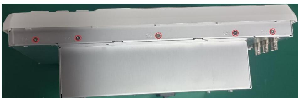
2、使用 T10 内梅花螺丝刀拆下左右两侧 4 颗螺丝，如下图：
