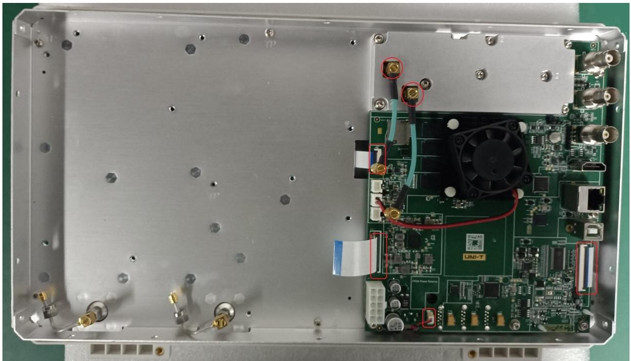
2、使用 T10 内梅花螺丝刀拆下前盖板组件固定数字中频板的 13 颗螺丝，如下图：
