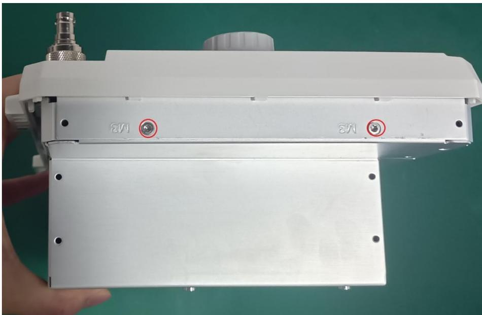
3、将设备面板朝下放置在软垫上，小心向上取后盖组件，并去掉连接前盖组件和后盖组件的连接线，如下图：
