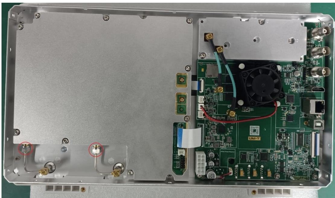
3、使用 T10 内梅花螺丝刀拆下前盖板组件固定腔体的 9 颗螺丝，如下图：
